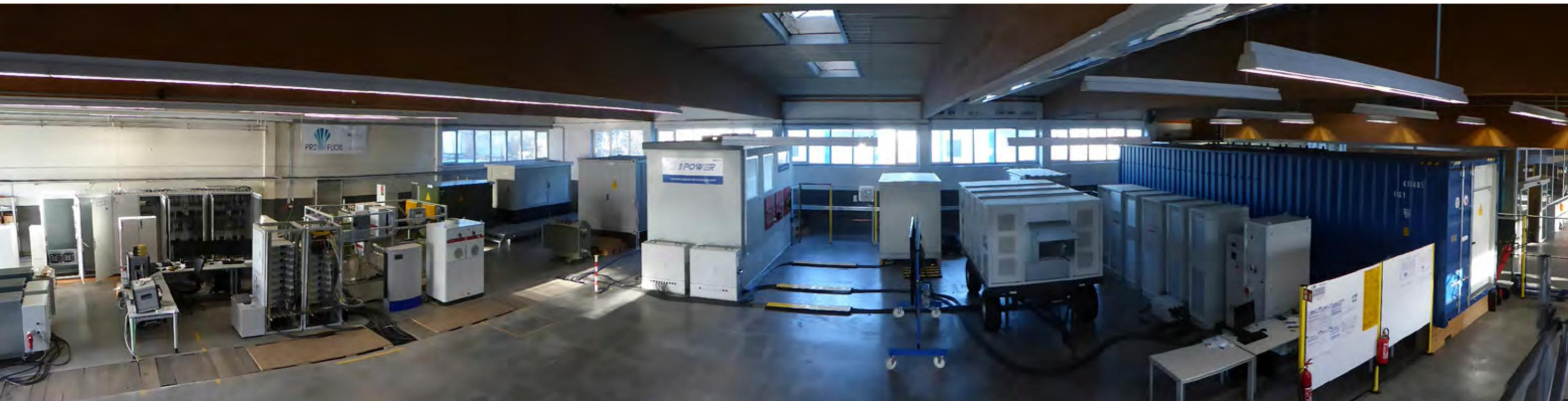
Abbildung 30: Laborübersicht, links Wechselrichter und Laborsteuerung, mitte Netzstationen, rechts Niederspannungsnetzsimulator und Spannungseinbruchstestsystem; IFHT
