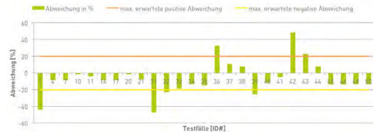
Abbildung 18: Prüfergebnisse – selektive Fehlereingrenzung (Laborumgebung); FGH
