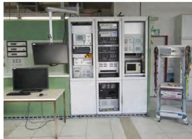
Abbildung 17: Prüfinfrastruktur für Schutz- und Leitgeräte der TU Dortmund
